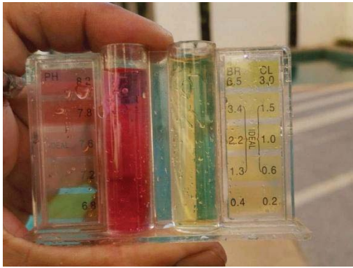
ภาพที่ 3.5.4-2 การตรวจวัด pH และ \text{Cl}_2 สระวายน้
